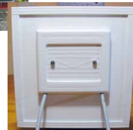
Dieser Kasten an der Vorderseite des Aufliegers dient nicht nur als Blickfang, sondern auch als Halterung für den Stecker zum Anschluss an das Zugfahrzeug
