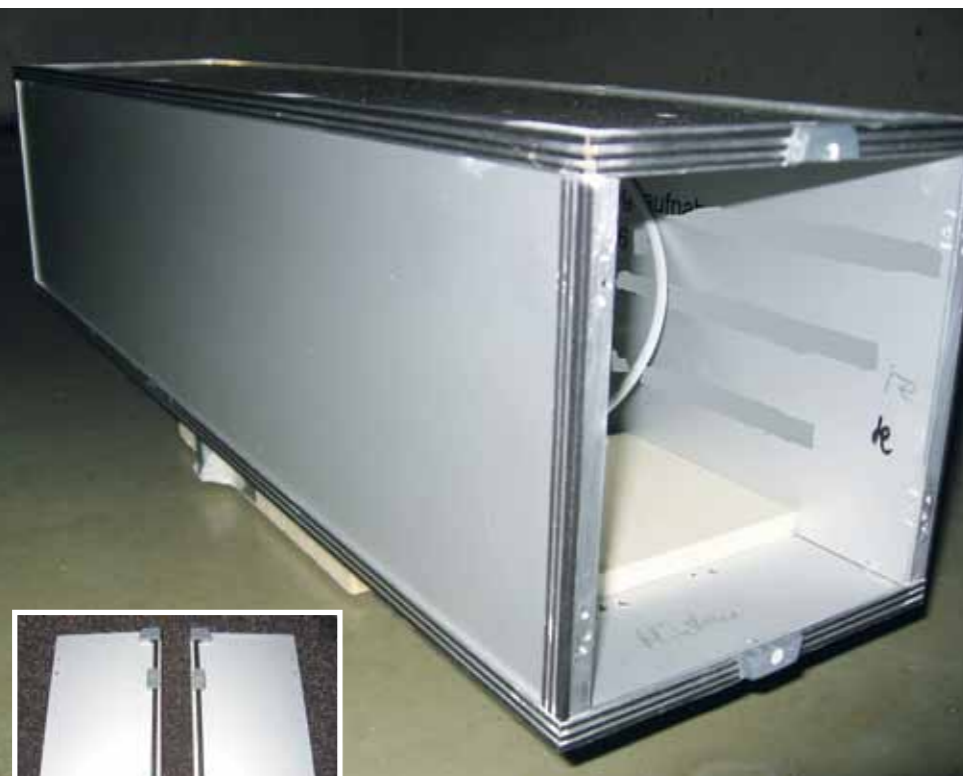
Der fertige Auflieger und die Türen bereit für die Farbe. Gut zu erkennen ist der Rahmen aus Klebeband, der dem Container nach der Lackierung die entsprechende Struktur verleiht
