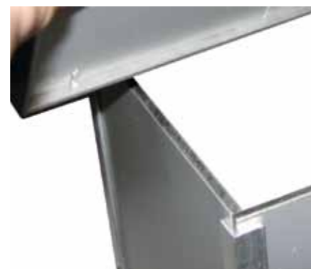
Die Wand des Aufliegers besteht aus zwei 4 Millimeter dicken Aluminiumplatten. Zur Verstärkung und als Abstandhalter sind dazwischen Kunststoffplatten eingelassen
