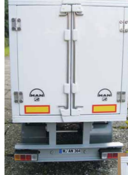
Die Rückseite des fertigen Aufliegers. Die Verriegelung wurde aus rostfreiem Stahl angefertigt
