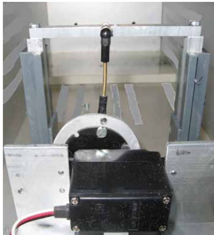
Vorder- und Rückseite der Ausfahrkonstruktion für die Aufliegerstütze. Das Servo muss genau eingestellt werden, damit die Stützen auf der richtigen Höhe maximal ausgefahren sind
