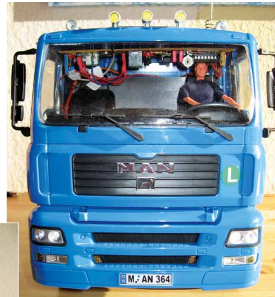
Aus dieser Perspektive ist die Platine unter dem Fahrerhausdach gut zu erkennen
