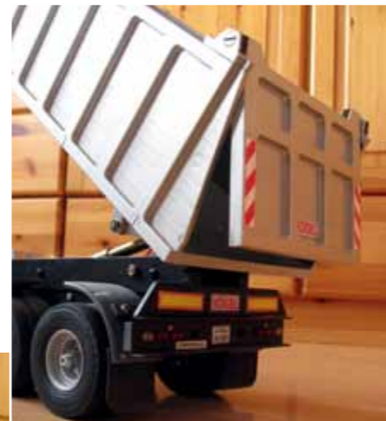
In der Heckansicht wird die automatisch bewegliche Klappe erkennbar
