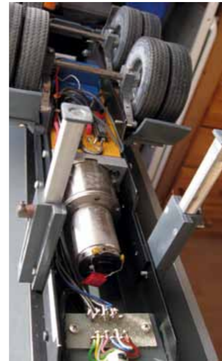
Blick auf die Stützen und die selbstgefertigten Achsen
