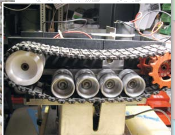
Weißer Umlenkrolle auf Messingwelle, kugellagerte Laufrollen und Antriebswelle
