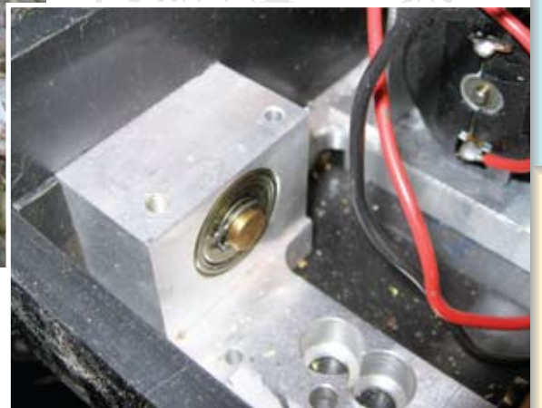
Kugellagerter Lagerbock für Messingwelle der weißen Umlenkrollen
