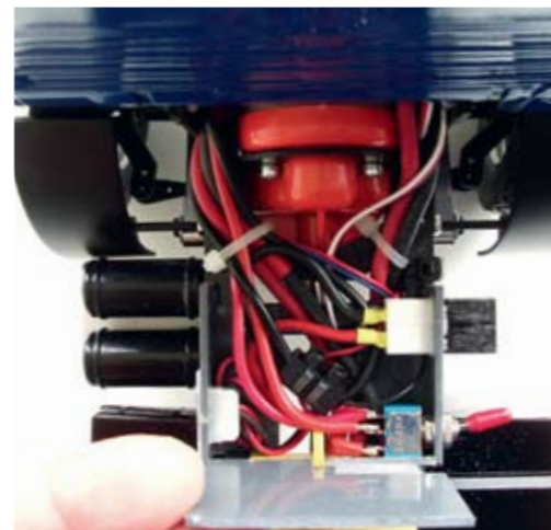
Blick auf die Lade- und Schaltelemente. Die Verlegung der Kabel in den beengten Platzverhältnissen erforderte etwas Fingerspitzengefühl
