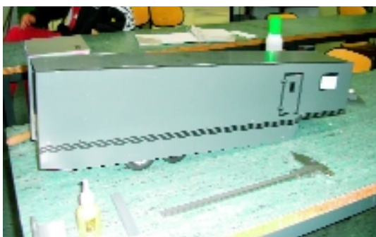
Der Auflieger mit eingefrästen Konturen
