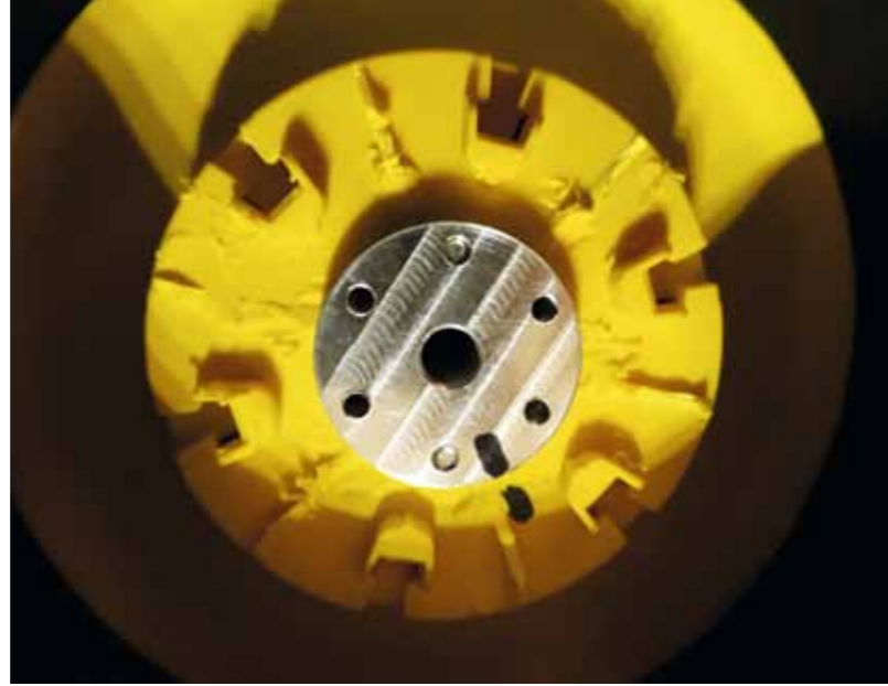
Um die Adapter einbauen zu können, wurden die Original-Felgen aufgebohrt und ausgefräst
