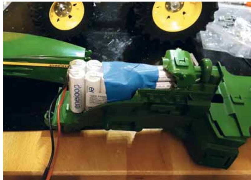
Der 12-Volt-Akku wurde neu verbunden, um unter die Motorhaube zu passen
