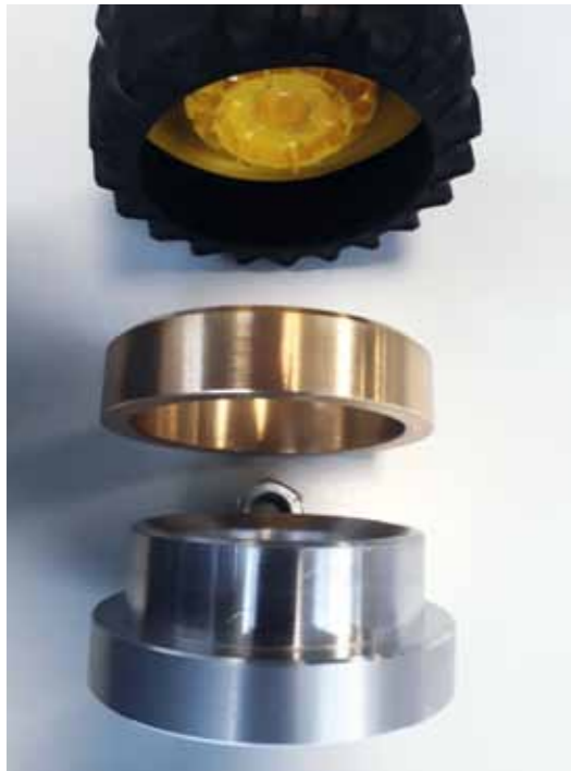
Zur Stabilisierung erhielten die Vorder- und Hinterreifen Aluringe (vorne), zur Erhöhung des Gewichts Messingringe (hinten)
