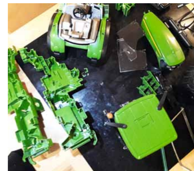
Um den Traktor vernünftig zerlegen zu können, galt es, die Halteclips des Traktors zu lösen
