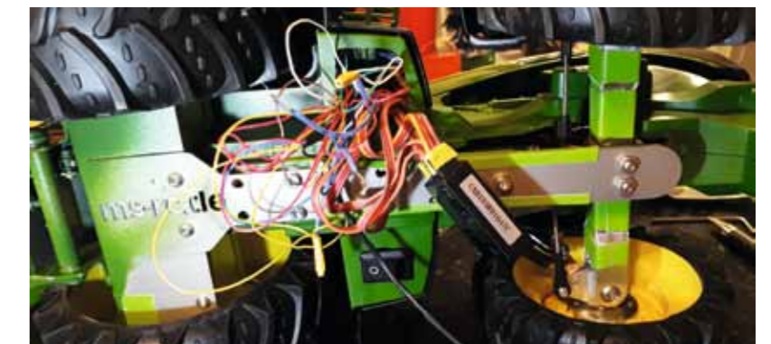
Blick von unten in das geordnete Chaos mit verbautem Ein-Aus-Schalter und Graupner-2,4-Gigahertz-Empfänger
