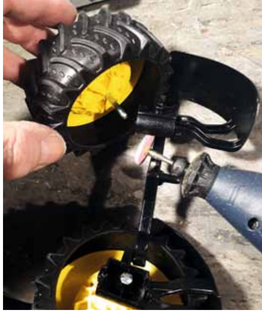
Die Trennung von Felgen und Achsen war nur mithilfe eines Dremels möglich
