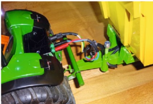
Traktor und Anhänger sind über eine fünfpolige Steckverbindung verknüpft
