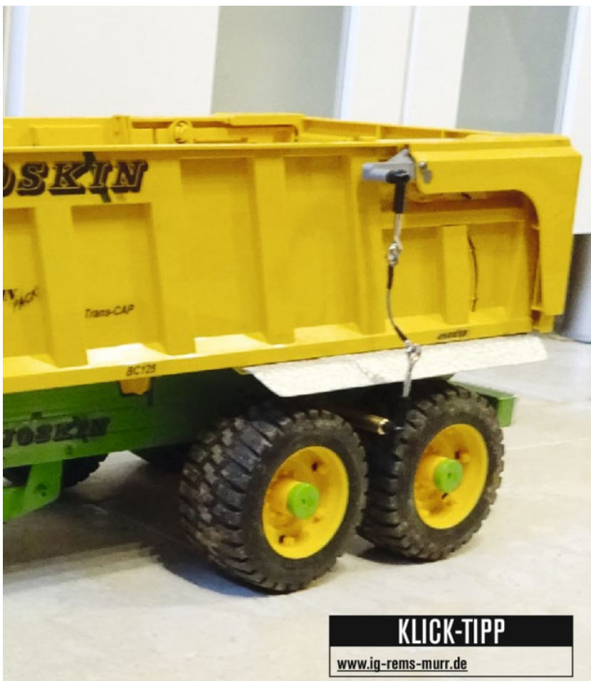
Auch die weiße Aufnahme für Trapezspindel und Getriebemotor ist im 3D-Drucker entstanden
