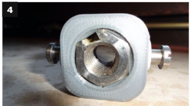
1) Für das Gegenlager zur Spindel ist in der weißen Aufnahme eine Messingbuchse eingepresst. 2) Um die Kippmulde zu begrenzen, sind die Endschalter direkt mit verbaut, inklusive einer Diode für den Richtungswechsel des Getriebemotors. 3) Die halbrunde Aussparung in der Deichsel konnte am 3D-Drucker direkt mit eingearbeitet und gedruckt werden. 4) Eingepresste Trapezmutter
